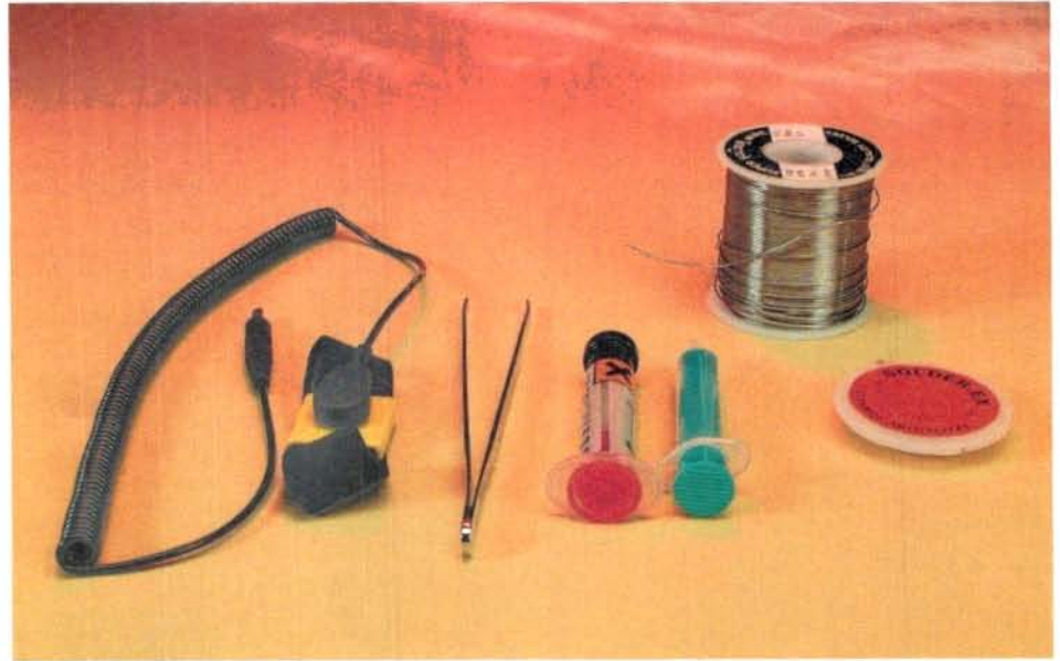
Figur 6. Grunduppsättningen med verktyg för att jobba med SMD-komponenter. Från vänster till höger antistatiskt handledsband, pincett, fluss, lödtenn och avlödningsfläta.
