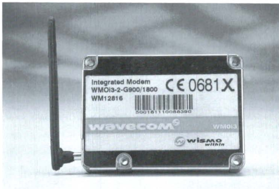
Figur 1. Projektets hjärta: Ett färdigprogrammerat GSM-modem från Unitronic.
