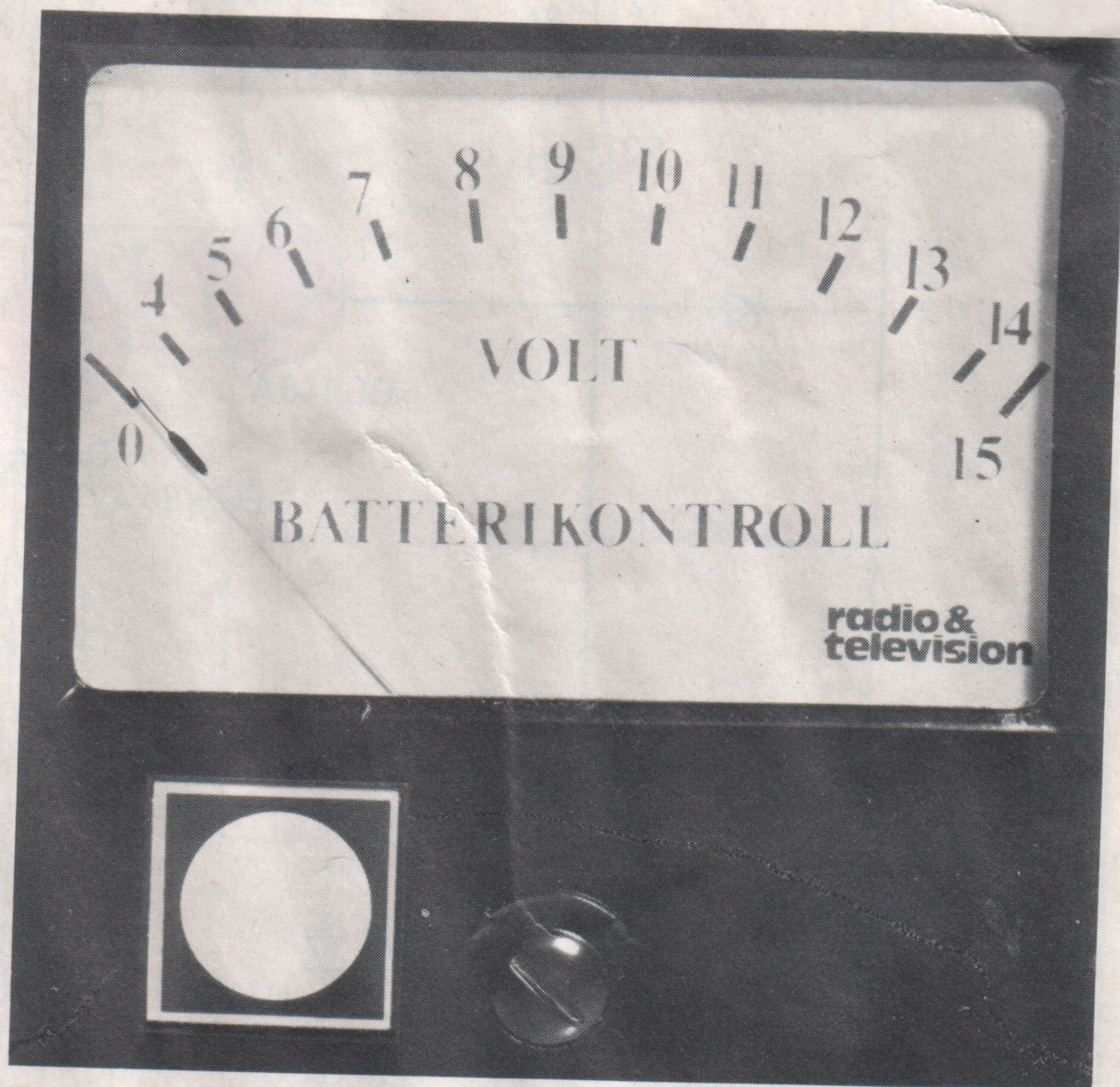
Fig 1. Batterikontrollinstrumentet färdigt för inbyggnad i bilen. Nertill t v syns en mekanisk beröringsbrytare som vi använt som återställningsdon i prototypen.
